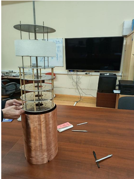
Механическая структура с пятью слоями и медный криогенный объем.
