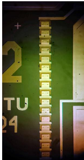
СИН термометр, изготовленный фотолитографией
