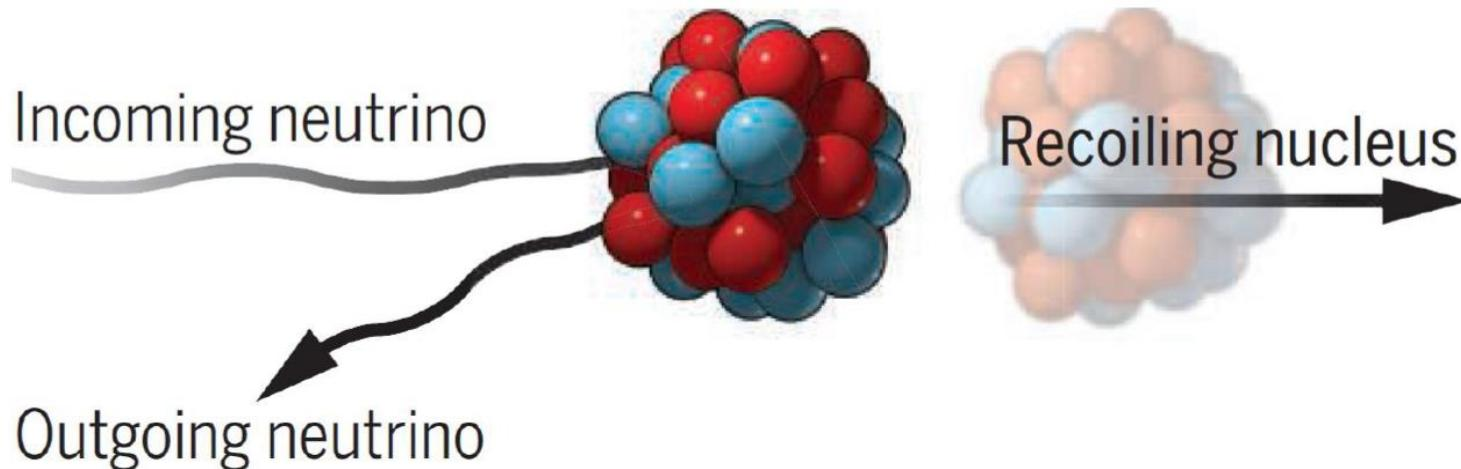
Нейтрино рассеивается на ядре атома. При этом внутренняя энергия ядра не меняется, а амплитуды рассеяния на отдельных нуклонах ядра складываются когерентным образом. В Стандартной модели:
