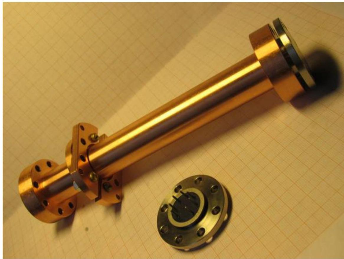
Ячейка имеет цилиндрическую геометрию и размещается вертикально, а верхний и нижний торцы закрываются фланцами из нержавеющей стали с индиевым уплотнением, через которые осуществляются электровводы генераторов и детекторов.
